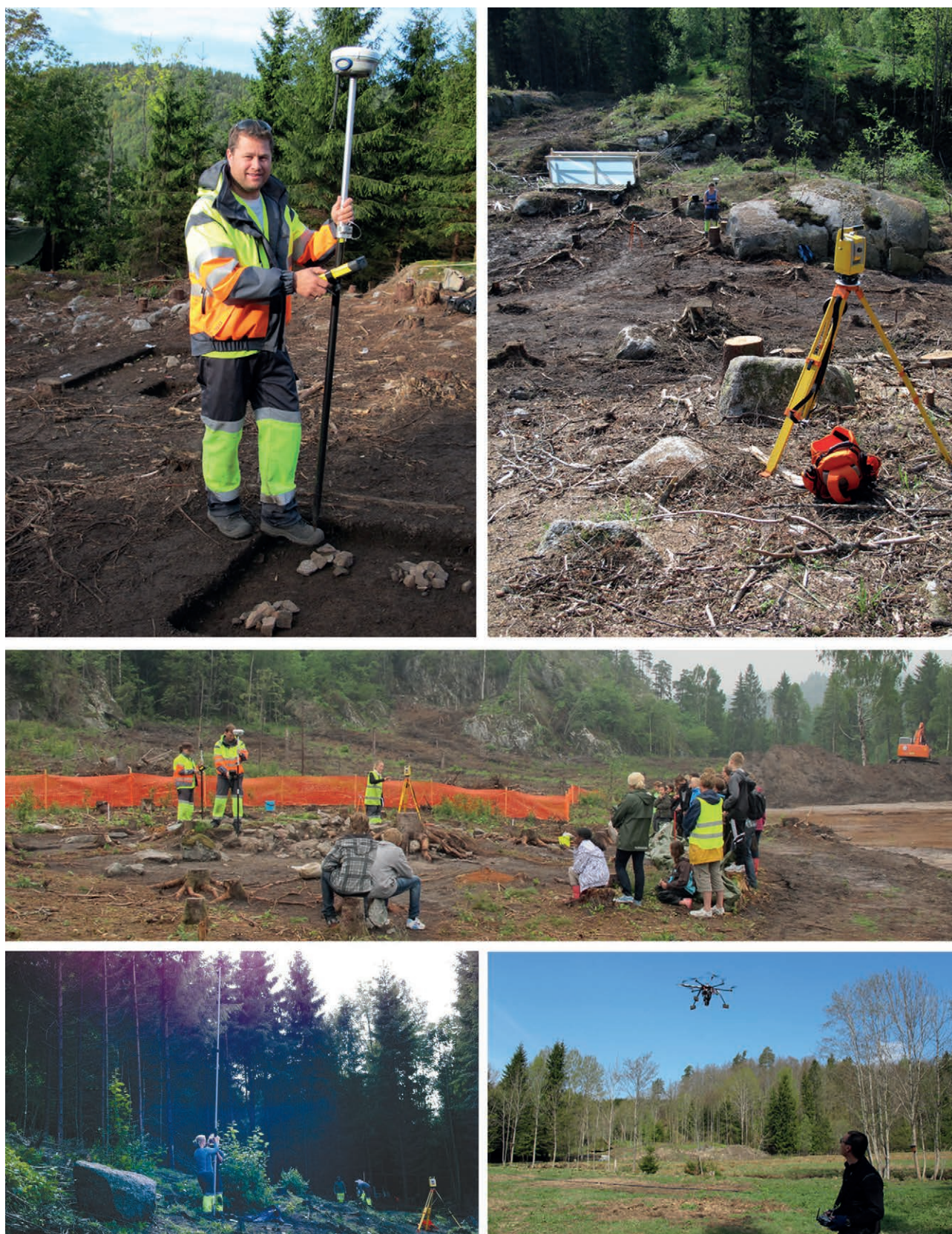
Figur 2.7.1. Digitalt utstyr brukt ved utgravningene. Øverst: utsetting av fastpunkt og koordinatsystem ved hjelp av GPS og totalstasjon. Midten: steiner i gravhaugen på Herregårdsbekken måles inn. Nederst: fototårn og mikrokofter i bruk.
