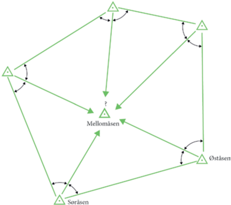
Figur 12.1 Triangulering i terrenget: Ved å måle vinklene mellom to kjente og et ukjent punkt (Mellomåsen), kan beliggenheten (koordinatene) til det ukjente punktet bestemmes. Desto flere kjente punkter en kan bruke, desto sikrere blir koordinatene til Mellomåsen.
