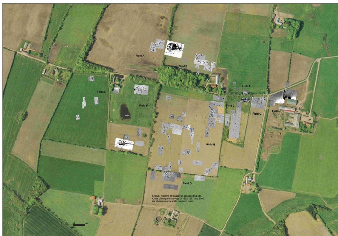
Figur 8: Snorup. De magnetisk kortlagte områder af jernudvindingspladsen er lagt ind på et luftfoto. Pladsen er 900 m fra vest til øst og 600 m fra syd til nord og består af 4–5.000 slaggegrube ovne. De to hvide felter viser totalt udgravede klynger med slaggegruber. Kortlagt af T. Smekalova.
